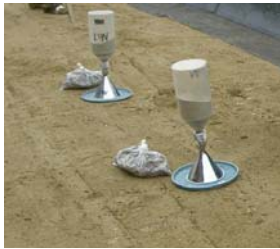
砂置換による土の密度試験
