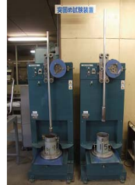
土の締固め試験
